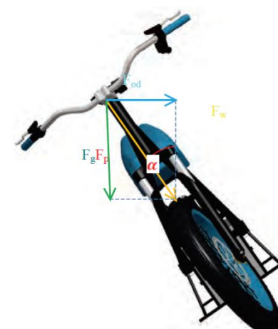
Rys. 1. Siły działające na motocykl podczas ruchu po łuku [2].
