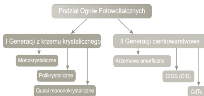
Rys.2. Podział ogniw fotowoltaicznych ( http://www.kolektory.biz/podzial-modulow-fotowoltaicznych/ 2018)
